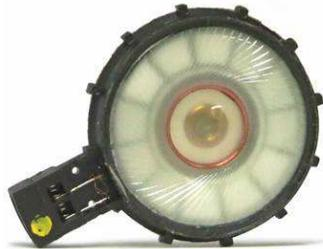
Come si può vedere nella fotografia di un auricolare smontato nell'area centrale è collocato il magnete e attorno sono avvolte un certo numero di spire. Le nostre misure in campo statico su una cuffia hanno evidenziato valori dell'ordine di 120 Micro Tesla dovuto al magnete permanente nell'area esterna a contatto con l'orecchio.
